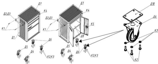
Пластина (Д10) служит для выравнивания высоты неповоротной колесной опоры (Д6). Прикрепить к дну тележки две колёсные неповоротные опоры (Д6) через пластину (Д10) винтами М6х16 (К2) и шайбами М6 (К3) со стороны противоположной ручке (для удобства установки колёсных опор возможна установка тележки на ровной поверхности, предварительно проложив картоном, линолеумом и т.п.).
